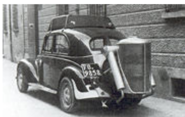
Un'auto di Ilario Bandini dotata di un impianto gasogeno.
